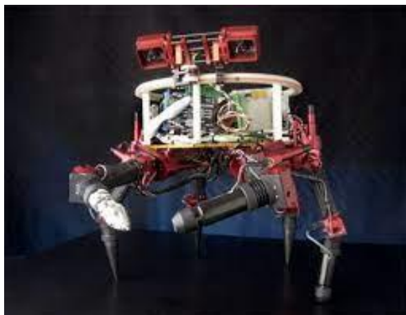
Рисунок 1.3.3 – Робот LEMUR III от Лаборатории реактивного движения NASA
